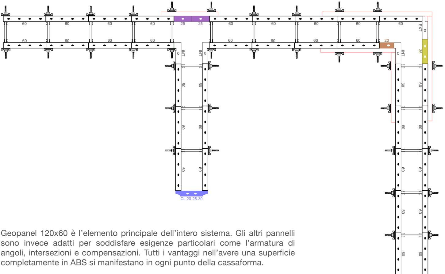
Geopanel 120x60 è l'elemento principale dell'intero sistema. Gli altri pannelli sono invece adatti per soddisfare esigenze particolari come l'armatura di angoli, intersezioni e compensazioni. Tutti i vantaggi nell'aver una superficie completamente in ABS si manifestano in ogni punto della cassaforma.
