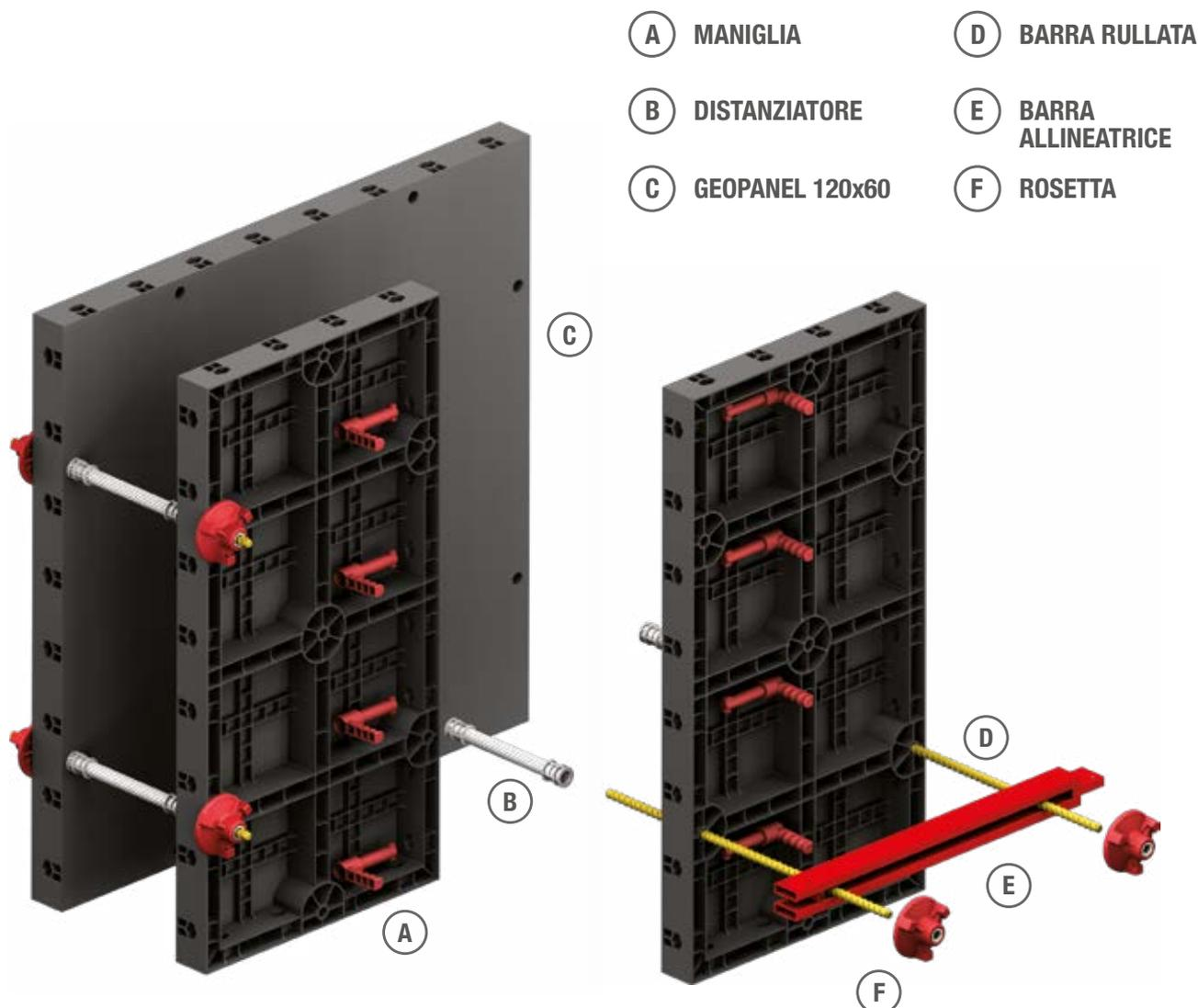
Con Geopanel 120x60 si casserano facilmente muri di altezza variabile da 0.6 m fino a 3.6 m. Gli altri pannelli della famiglia Geopanel permettono di eseguire piccoli aggiustamenti in altezza.
